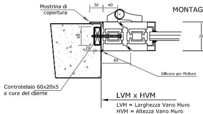
MONTAGGIO A SPIGOLO (lato cerniera)
